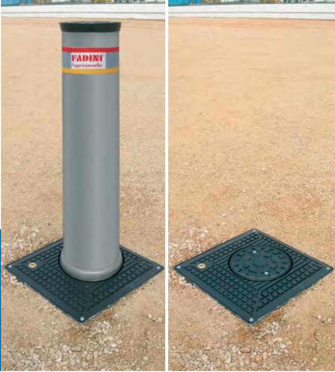
Colonna Vigilo 2280 in posizione alta dissuasiva e abbassata totalmente a pavimento.
