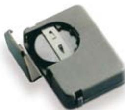
Trasmittitore 2 canali con alimentazione a batteria collegabile agli interruttori esistenti con funzione pulsante. Segnalazione acustica di batteria scarica
